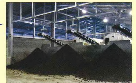
一次処理された堆肥を堆積 (移動排出コンベヤ)
