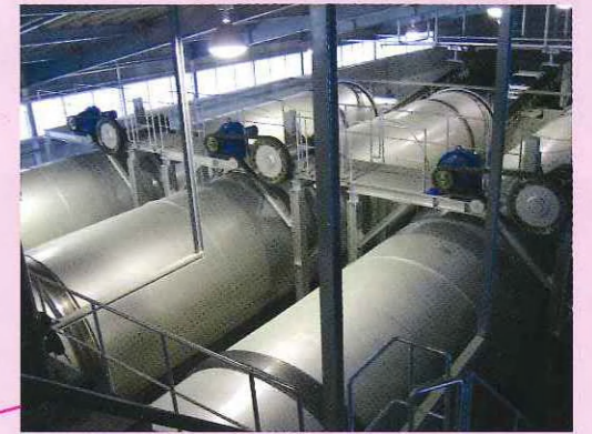
投入された処理原料を一次発酵堆肥化処理 (横型密封回転強制発酵機)
